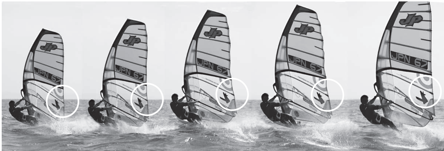
陸上でセイルを見た場合、ブームエンドすぐ上のリーチに張りがあることが判る。目安となるのはバテン。丸で囲んだ部分にルーズさがないように、繊細にアウトホールのテンションを調節してやろう。時にはテンションに強弱を付けて試し乗りをしてみた方がいい。
