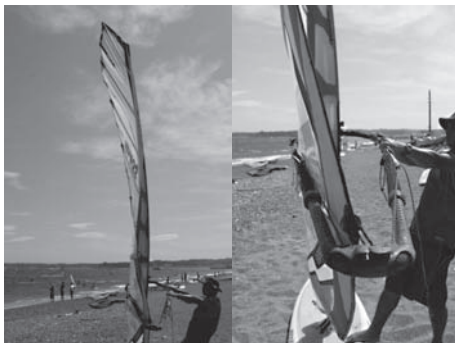
アウトテンションを緩めたところ。ブームにセイルがくっつくほどに緩い状態だが、リーチがソフトになって効率良く開いてくれるため、アビームや下りの走りに適している。
