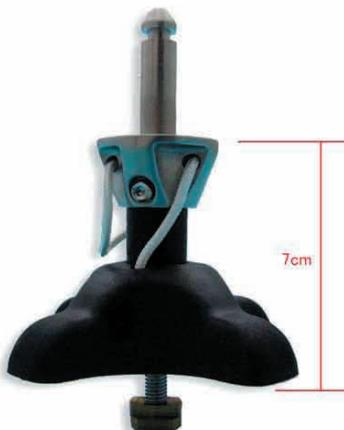
“より耐久性を求め、よりコントロールに”をモットーに、ライダーの長期に渡るテストライドにより改良を重ね発表されたJOINT BASE。今まで高さが9cm前後だったジョイントベース。POWERIG PIN-TYPE JOINT BASEはその高さを約7cmに抑えることに成功。ボードに2cmセイルが近づくことによりセイルのバランスが極めて良くなり、セイルパワーはよりダイレクトにボードに伝わる。たった2cmだが、ブームの高さも2cm上げることにより、よりセイルを軽く使用できる。
