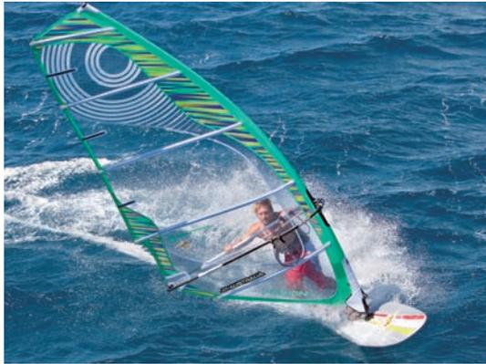
フリーライドセイルとしての基本性能を全て持ち合わせているのが、この"FUSSION"。RDMでセッティングすれば、ローエンドに強いしなやかさを得ることができ、NDMで張り上げれば、トップエンドスピードの高いセイルに仕上がる。どんなセーリングをしたいの
