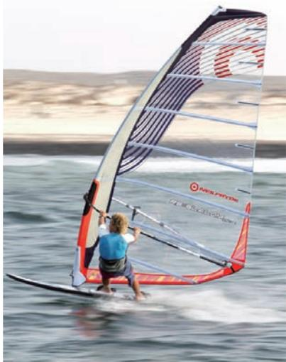
セイルのアウトラインをそのままつなげた状態でクリューを組み込んだ"一体化したコンパクトクリュー"デザインを採用。クリューを埋め込んだことでセイルの安定性、ハンドリング、使用風域が向上し、アウトラインをそのままつなげることによって、セイルの必要箇所にテンションを与えると共にリーチ中央の安定性を高めると共にフットのツイストを最大限に高め、セイルパワーを無駄に分散させることなくセーリングできるようになった。EVO IIIのデザインに限りなく近いデザインとしつつも、マストスリーブを狭くし、カムの数を減少させ、全体の軽量化も図られている。ローエンドでの優れた加速、トップエンドのハイスピード性を持ち、使いやすくて速いセイルに仕上げられている。
