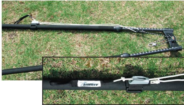
ベルクロでクリートを固定。簡単にブームに取り付けることができる。別売のプーリーとブームエンド側ロープを使用することで操作性が格段にアップ
