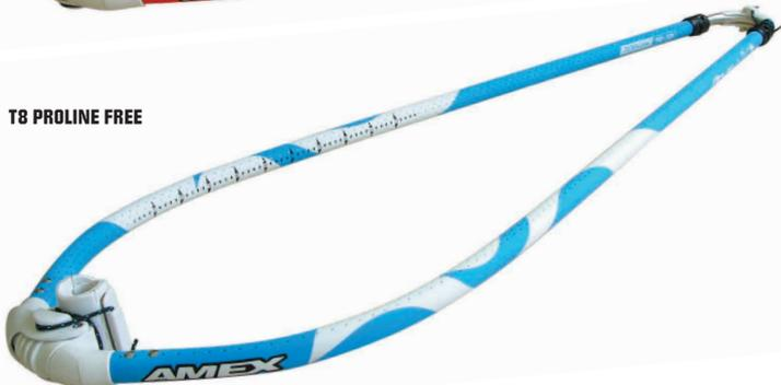
ビギナーに最適なカーブでありながら、多くのトップフリースタイラー・スローマーが好んで使用するナローカーブを採用。それらによって長きに渡り、幅広い層に支持されてされている。走っていて非常に楽なブームで耐久性に優れているのも大きな特徴。その秘密はアルミの肉厚を厚くし、アルミの弱点である耐摩耗性に劣るという欠点を補っているということ。また、耐摩耗性を克服するためには実用的な表面処理技術も施している。パーツには厳選されたものを自ら採用。可動式ブームジョーを採用し、マストへの取り付けたときのフィット感が非常に良い。マストプロテクターはSDM、RDM共に必要なく、そのままマストに取り付けることが可能である。冬場の寒い時期などにも威力を発揮する。
